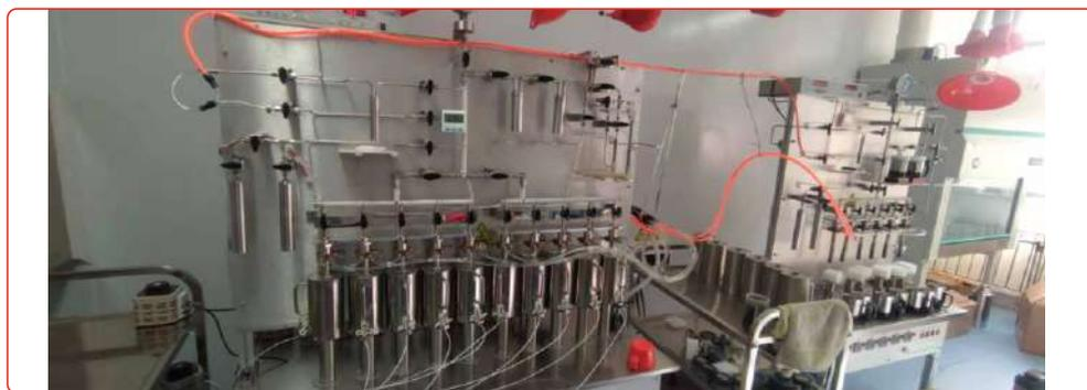
基于定制硅酸盐制样台的石英、硅酸盐全岩、氧化物的Si、O同位素测试方法。设备再升级,新定制硅酸盐制样台,加标样可同时进行10个样品的制备,加上第一代的制样台的5个,效率提升至300%。
