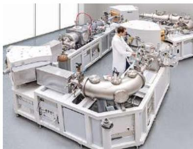
300kV 多核素小型加速器质谱仪(MILEA)，具有占地小(7m×3.5m×2m)、轻量化(15 吨)、低功耗、易操作、少维护、全自动、高效率、高精度、可测量微量气体样品等特点，支持 <sup>10</sup>Be, <sup>14</sup>C, <sup>26</sup>Al, <sup>41</sup>Ca, <sup>129</sup>I 及 U, Pu, Np, Am, Cm, Cf 等核素分析，可用于考古学、环境科学、海洋科学、材料科学、生物医学等领域研究，可以进行冰川侵蚀、剥蚀速率等地质科学研究，还可以进行辐射安全、退役核电站、核废料存储等核科学领域研究。参考用户：中国辐射防护研究院、捷克科学院核物理研究所、英国兰卡斯特大学。
